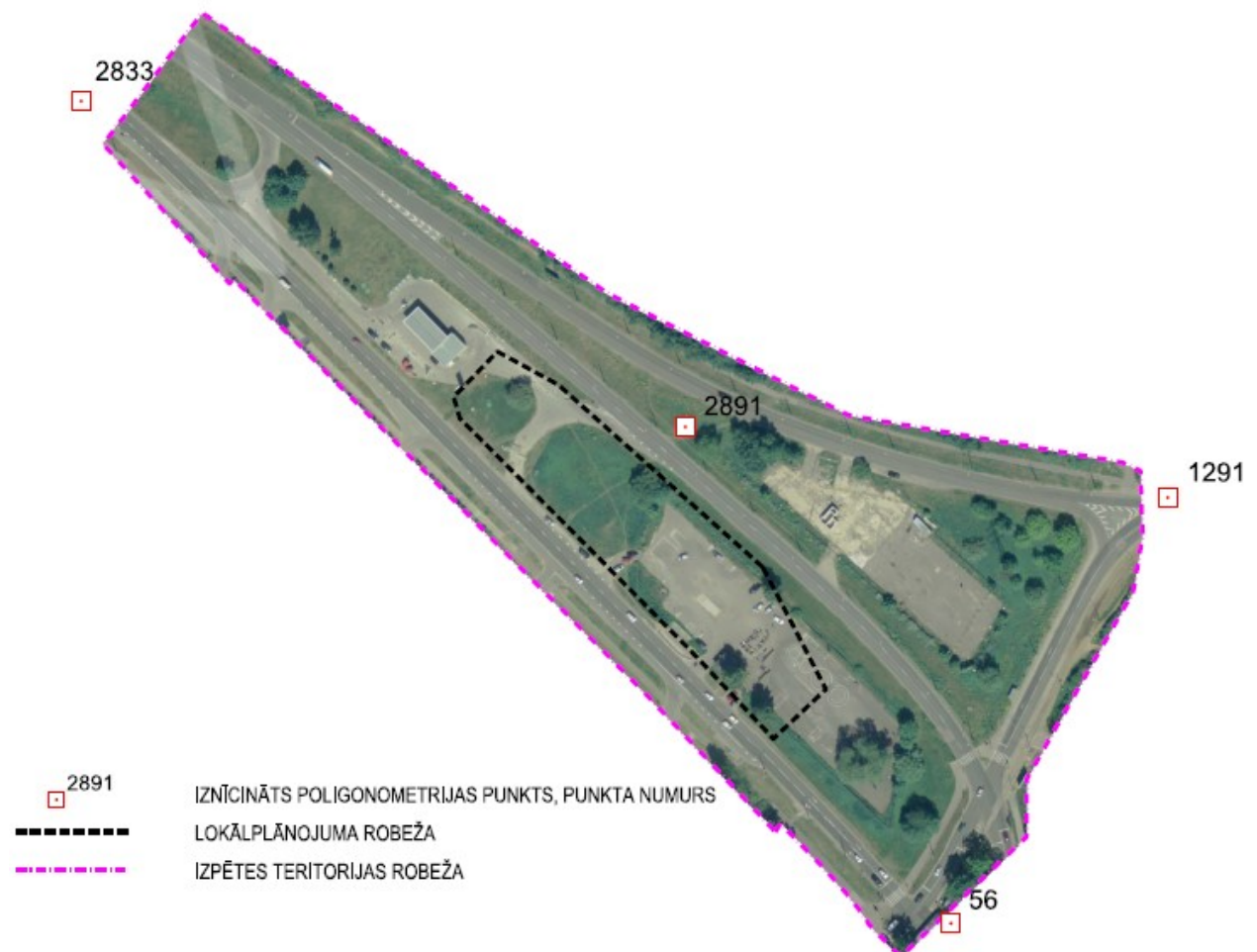
23.attēls. Shēma par lokālpārplānojuma izpētes tuvumā iznīcinātajiem poligonometrijas punktiem. Avots SIA "METRUM", 2016.
