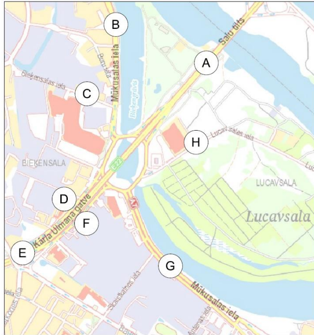
Attēls Nr.24.1 Satiksmes plūsmu virzienu shēma Mūkusalas aplī Tabula Nr.7.1.Plūsmu sadalījums un ceļā pavadītais laiks pa virzieniem rīta maksimuma stundā pie esošajām intensitātēm.
