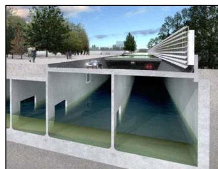
Attēls nr. 22. Lietus ūdens savākšana un uzglabāšana zem pazemes autostāvvietas.
