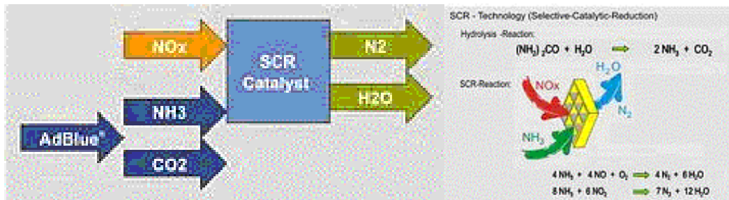
22. attēls. Ķīmiskais process SCR katalizē
