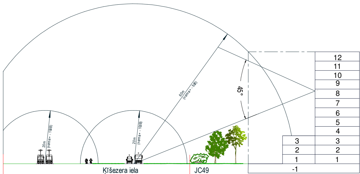
17.attēls. Skaņas viļņa atstarošanās un refrakcija lokālpārplānojuma teritorijā pie Ķīšezera ielas.
