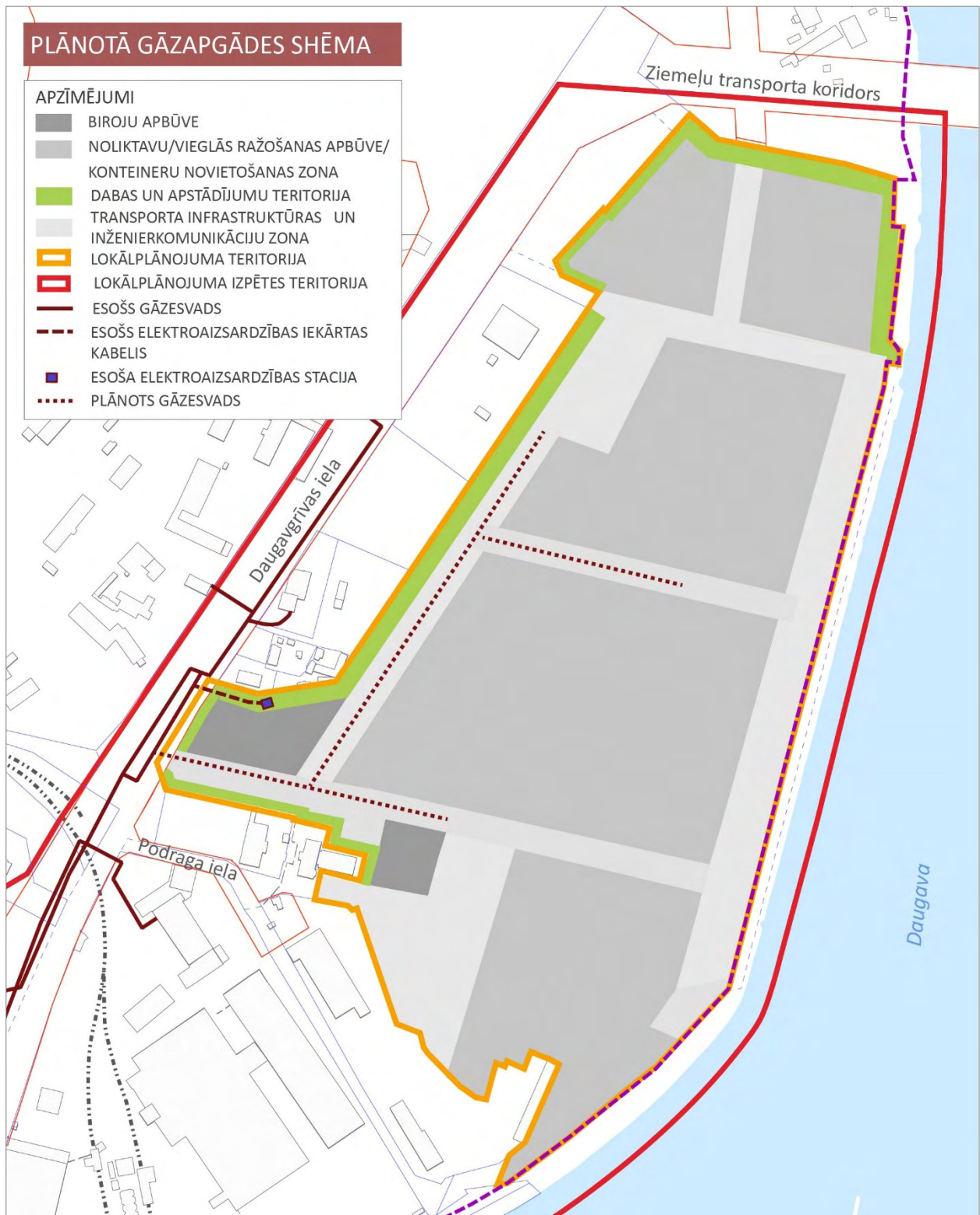
53. attēls. Plānotā gāzapgādes shēma. Avots: SIA „METRUM”, 2017.
