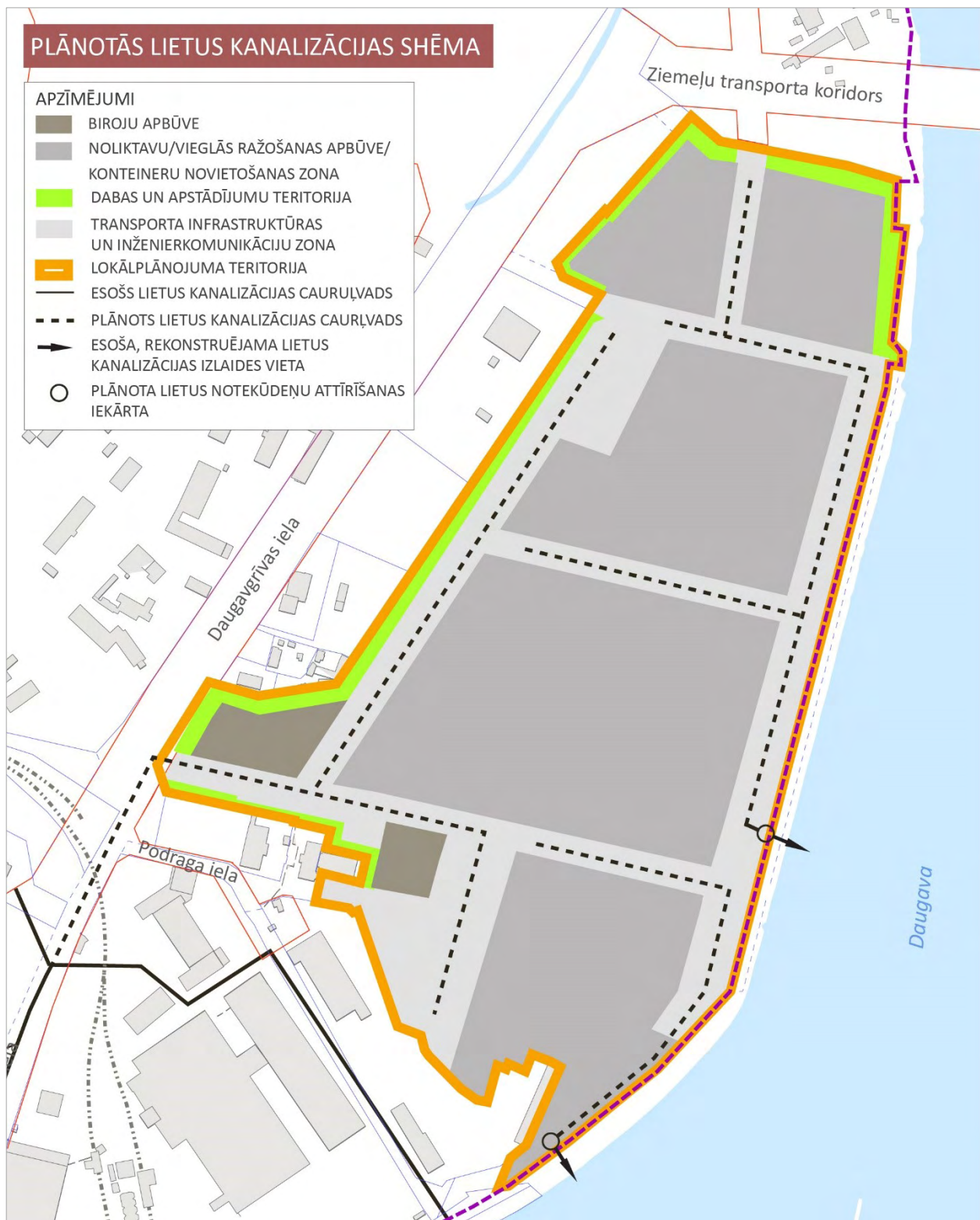
54. attēls. Plānotās lietuss kanalizācijas shēma. Avots: SIA „METRUM”, 2017.
