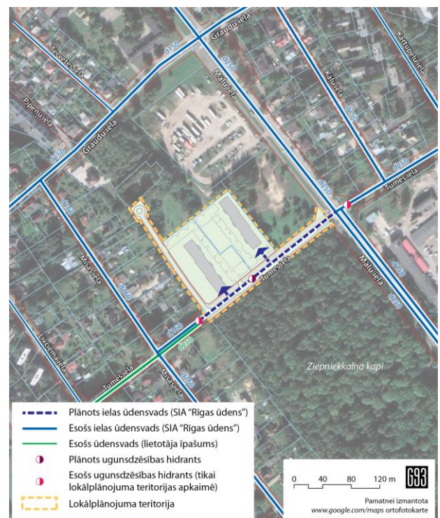
41.att. Ūdensapgāde - plānotā situācija, principiālais risinājums
