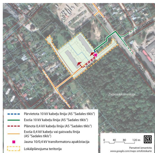
47.att. Elektroapgāde - plānotā situācija, principiālais risinājums
