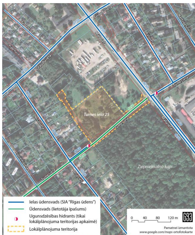
40.att. Ūdensapgādes apkārtnes kontekstā, esošā situācija
