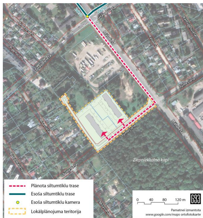
51.att. Siltumapgāde - plānotā situācija, principiālais risinājums
