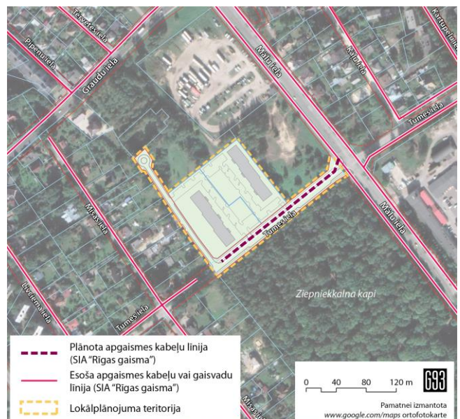
49.att. Apgaismojums plānotajā situācijā, principiālais risinājums
