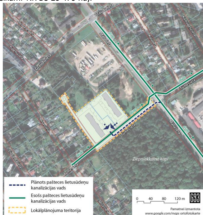
45.att. Lietus kanalizācija - plānotā situācija, principiālais risinājums
