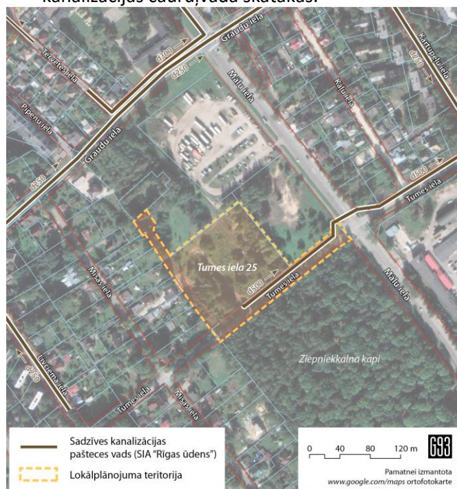
42.att. Sadzīves kanalizācija apkārtnes kontekstā, esošā situācija
