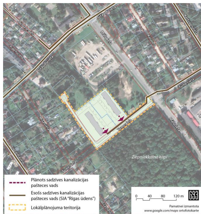
43.att. Sadzīves kanalizācija - plānotā situācija, principiālais risinājums
