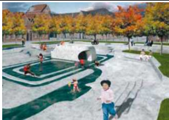
Att. nr. 28. ASV piemērs lietusūdens uzkrāšanai un novadīšanas iespēja uz infiltrācijas baseinu.
